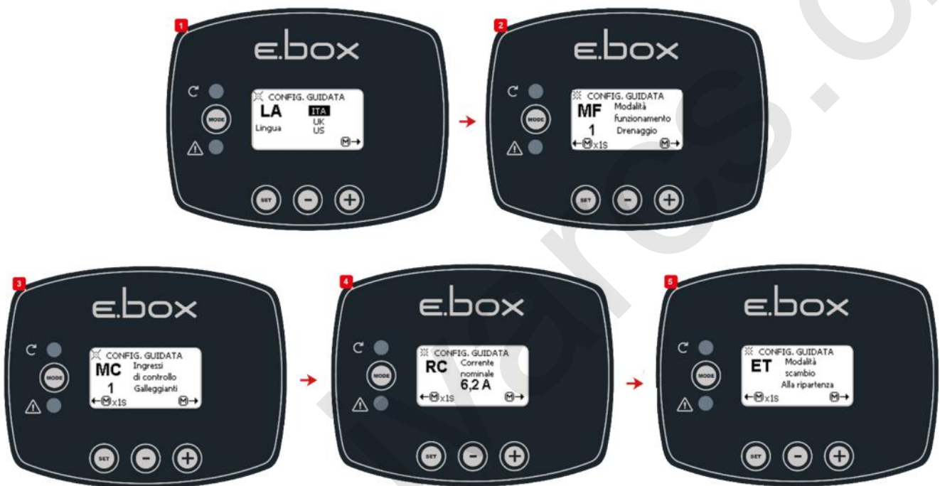
Obrázek 36: Nastavení vypouštění pomocí plovák nebo hladinových idel
