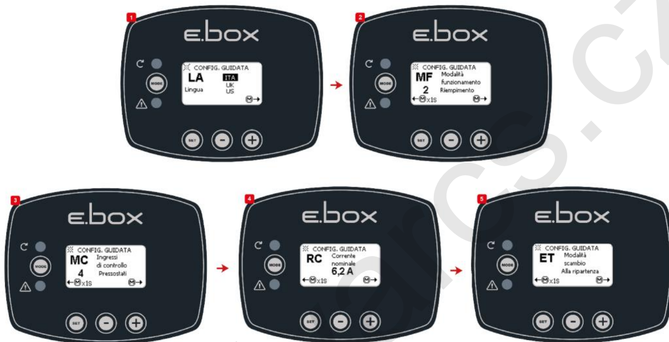
Obrázek 24: Nastavení pln ní pomocí plovák nebo hladinových idel
